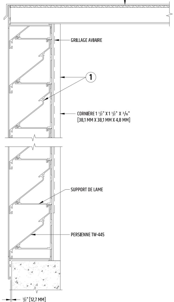
NOTES : 1- Lorsque la longueur des lames excède 48" (1 219 MM) pour les persiennes 2" (50,8 MM) et 60" (1 524 MM) pour les persiennes 4" (101,6 MM) et 6" (152,4 MM), des supports de lames ainsi que des poteaux intermédiaires en « U » de 1-1/2" x 1-1/2" x 0,14" (38 MM x 38 MM x 3,5 MM) sont posés à une distance maximale de 60" (1 524 MM).
