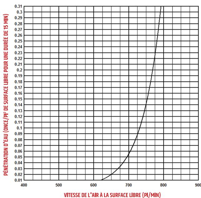
NOTE: Tests de pénétration d'eau et de perte de pression effectués par les laboratoires Air-Ins, conformément à la norme AMCA 500.
